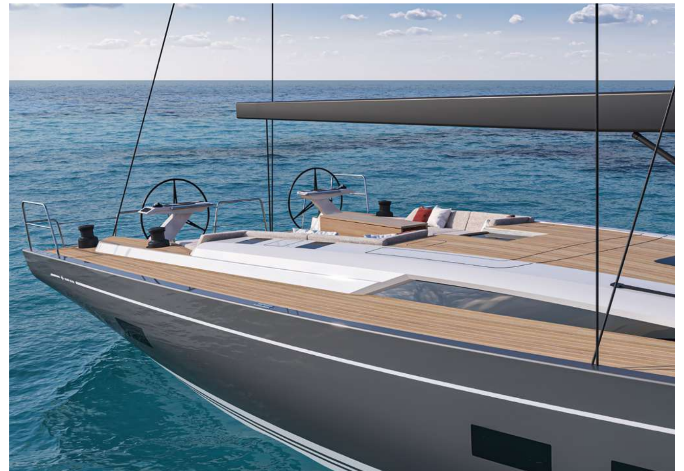
Il piano di coperta del Grand Soleil 65 Performance, con una disposizione intelligente del piano velico e dell'attrezzatura per manovre facilitate e ampio spazio esterno a bordo.
