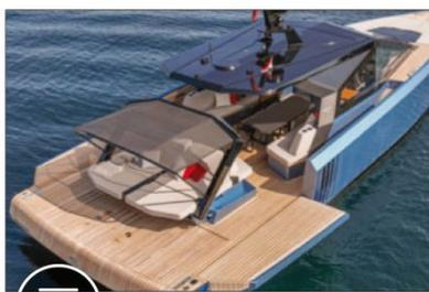
Wally innove en installant un astucieux bimini électrique escamotable qui vient ombrager le bain de soleil arrière. On peut le maintenir en place en vitesse de croisière, jusqu'à 25 nd
